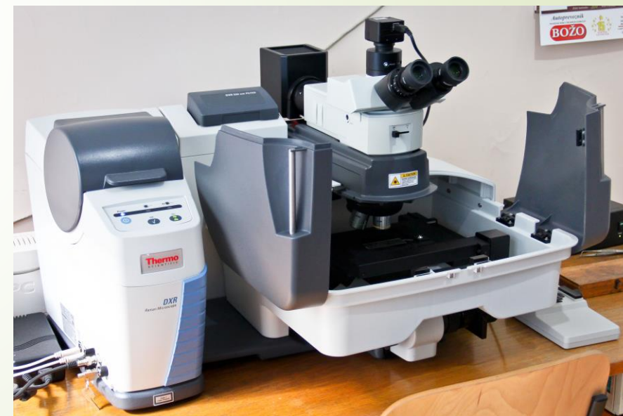
Экспериментальная установка: КР-микроскоп DXR Raman Microscope
